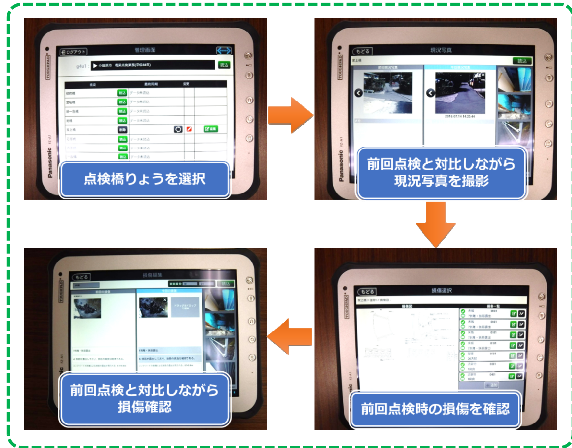
タブレットを用いた点検の効率化
